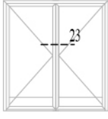
dışa açılır kapı outward opening door
