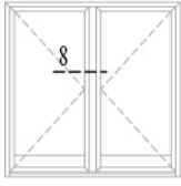
içe açılır kapı inward opening door
