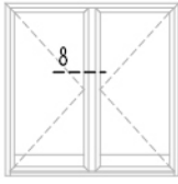
içe açılır kapı inward opening door
