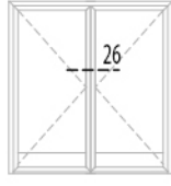
dışa açılır kapı outward opening door
