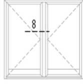
içe açılır kapı inward opening door
